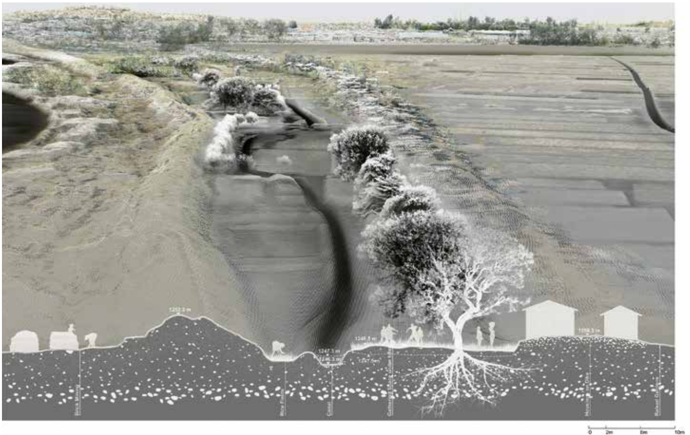
16 Perspective section of the agricultural landscape and earthworks along the Ikopa River in Antananarivo, designed using point cloud modelling and tested through hydrological simulation. Perspektivischer Schnitt der Agrarlandschaft und der Erdarbeiten entlang des Ikopa-Flusses in Antananarivo, entworfen mit Punktwolkenmodellierung und getestet durch hydrologische Simulation.
