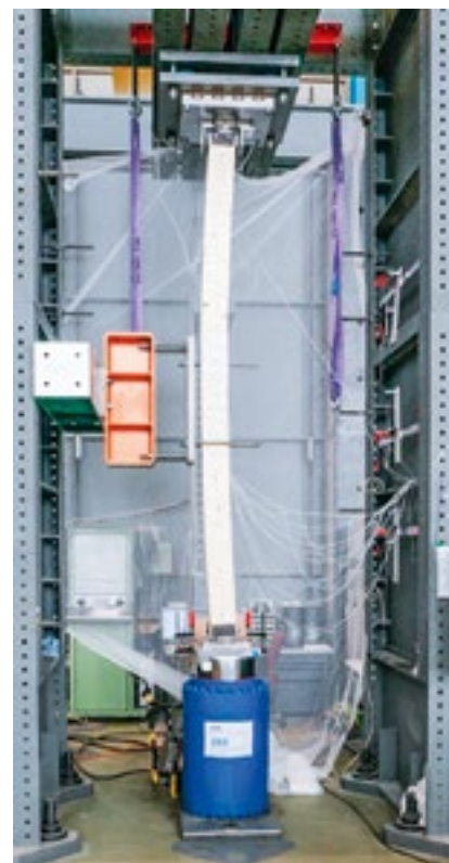
Knickversuche an Brettschichtholz-Stützen an der ETH Zürich
