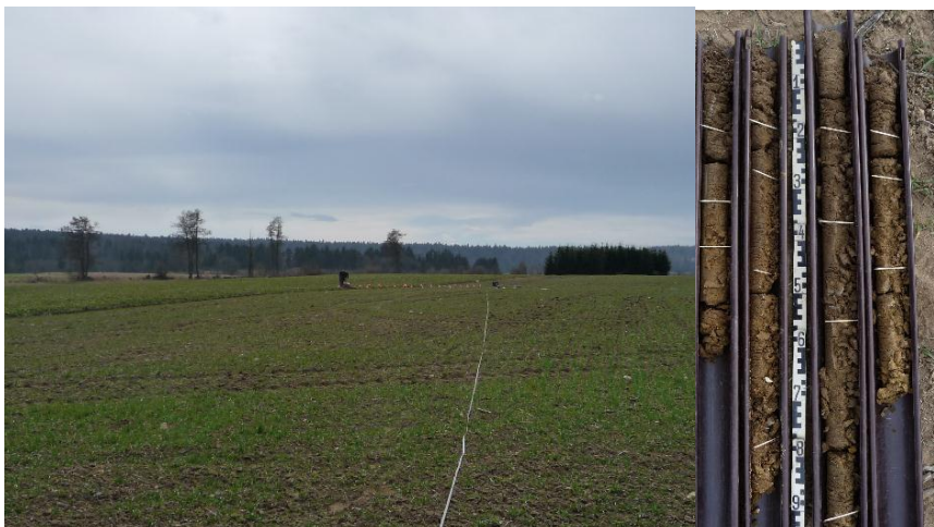
Abbildung 13: Ansicht NABO-Standort 31 und Bodentyp (Braunerde mit 21 % Ton, 18 % Schluff und 2.5 % Humus).
