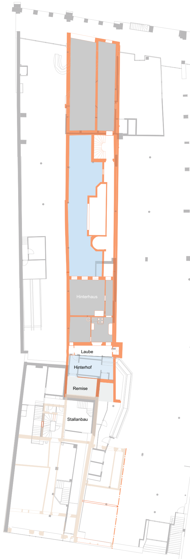
Marktgasse 42, Zeughausgasse 29 u. 31: in roter Farbe rekonstruierter Erdgeschossgrundriss vor dem Abbruch 1975, in grauer Farbe aktueller Grundriss Erdgeschoss: Haus an der Marktgasse mit hofseitigem ehem. Treppenturm, Hof mit westseitigem Seitengebäude, Hinterhaus, zweitem Hof und den beiden Bauten an der Zeughausgasse.
