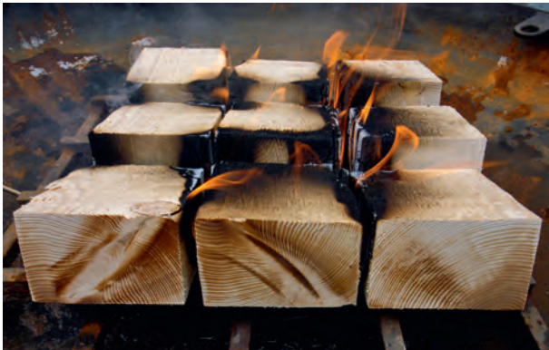
Ein Test am Modell zeigt, wie sich das Feuer an den Brettanten verhält.
