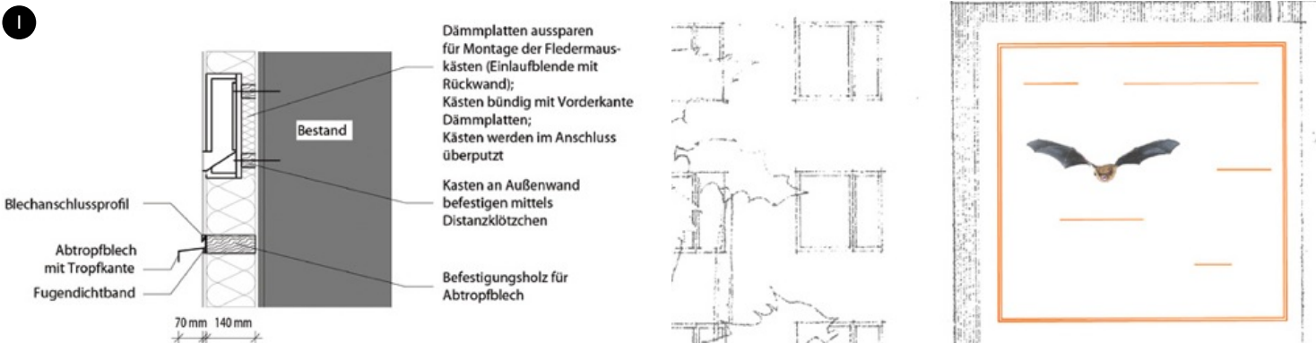
Schnitt Fassadenquartier: Quelle: Architekturbüro Hechenbichler, München
