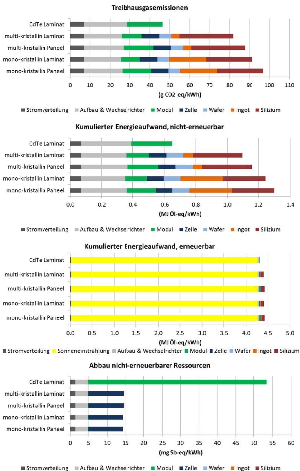
Abbildung 14 Umweltauswirkungen verschiedener PV-Technologien. Bezugsgrösse: 1 kWh Strom, Niederspannung. Die PV Anlagen entsprechen neuen 3kW p -Anlagen, die auf Schrägdächern in der Schweiz installiert werden. Jahresertrag Schweiz: 922 kWh/kW p . Paneeleffizienzen: mono-kristallin 14 %, multi-kristalline 13.6 %, CdTe 11.7 %. Lebensdauer: 30 Jahre. Berücksichtigt werden die Modulherstellung, Installation, Kabel, Wechselrichter, Unterhalt und Entsorgung.
