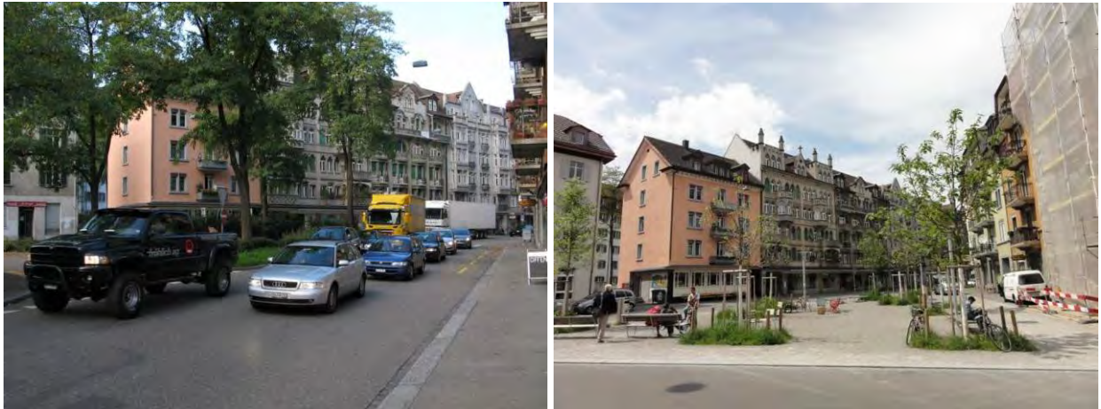
Abbildung 46: Brupbacherplatz, Nov. 2008 (links) und Sept. 2013 (rechts): Umbau der Strassenkreuzung West-/Gertrudstrasse zu einem Platz, Wegfall der Fahrbahn auf der Ostseite, Einführung von Tempo 30, neue Gestaltung mit Bäumen und Bänken
