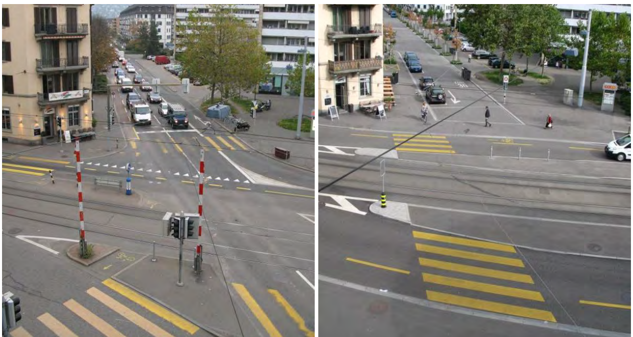
Abbildung 44: Sihlfeldstrasse, Nov. 2008 (links) und Sept. 2013 (rechts): Umbau zu verkehrsberuhigter Quartierstrasse mit Tempo 30 und Gegenverkehr
